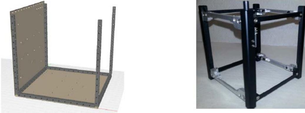
Figura 1.5 struttura meccanica di Aramis
