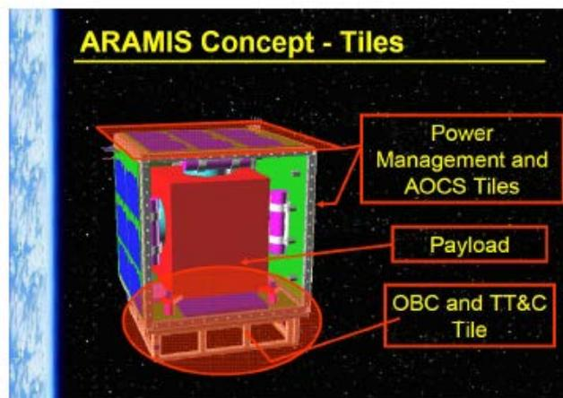
Figura 1.5 Visione di un satellite Aramis e delle relative tiles
