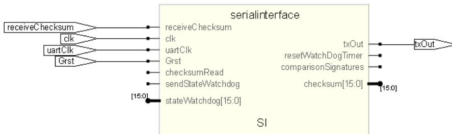
Figura 3.6: *Top della classe Serial Interface*
