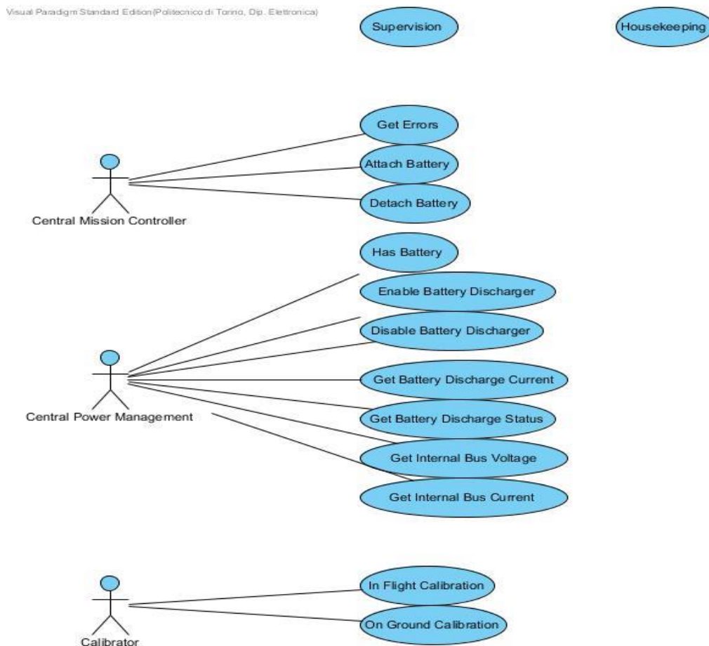
Figura 3.4: Esempio Case Diagram relativo a funzioni di AraMiS
