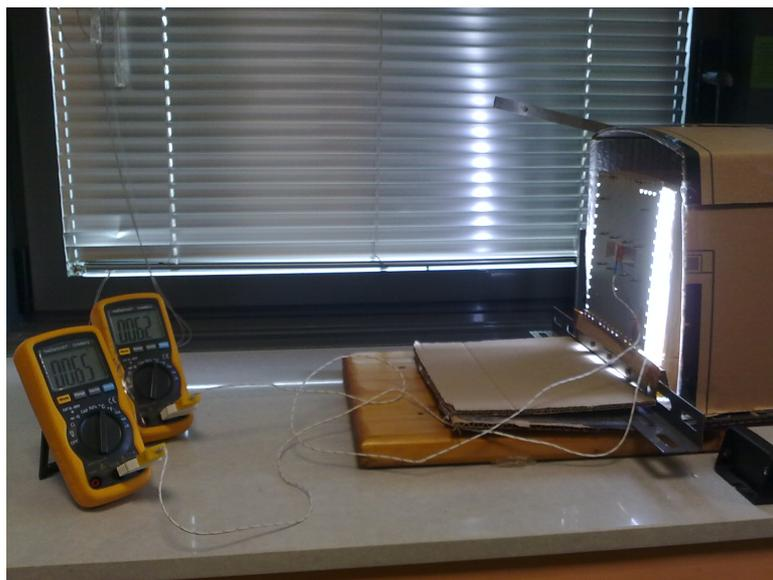
*Fig 15.1: Simulatore solare in funzionamento*
