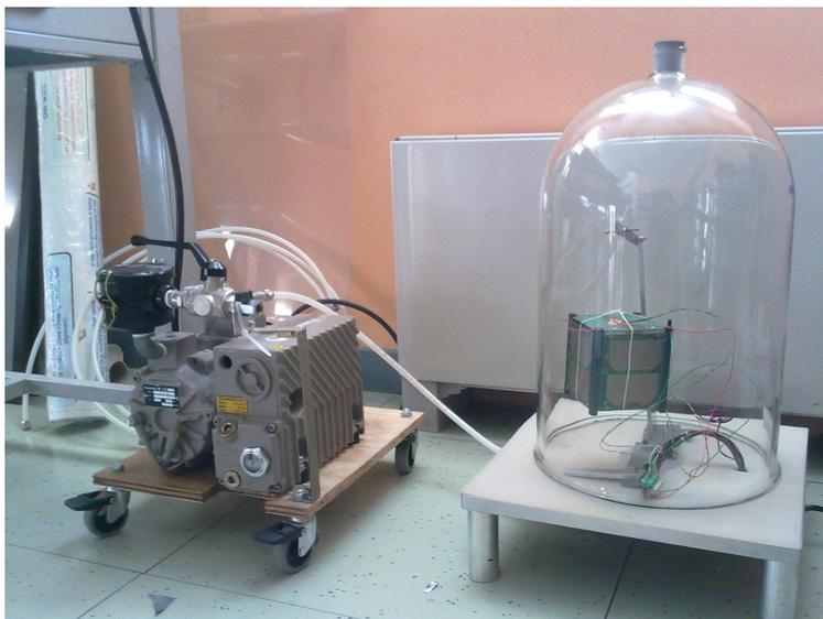
Fig 15.4: L'AraMiS\_C1 in fase di testing nel vuoto
