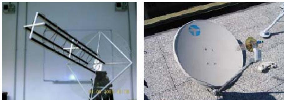
Figura 2.1 – Le antenne ad elica ed a paraboloide
