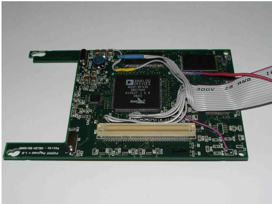
Figura 5.10 – Scheda Payload con il cavo necessario al collegamento con la scheda di interfaccia
