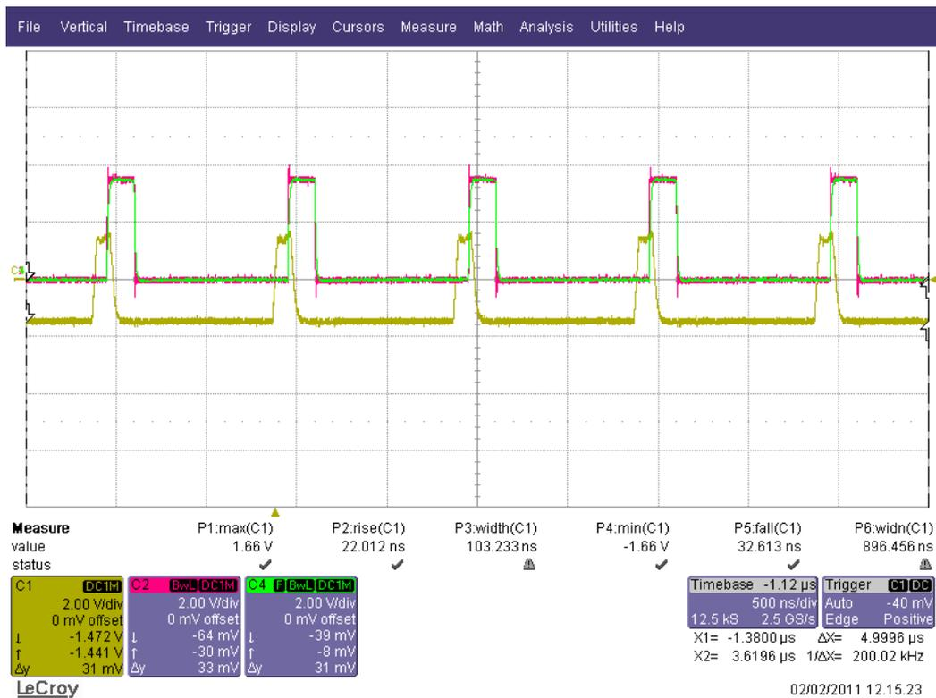
Figura 4.10 Segnale di prova trasmesso e segnali ricevuti sul pin RX dalle interfacce(segnali 6 e 7)
