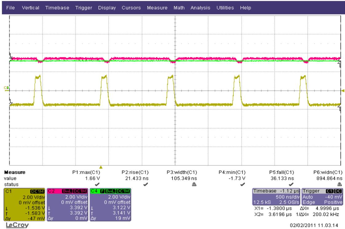
Figura 4.11 Segnali in ingresso al comparatore con guasto di tipo *a* su +DB (segnali 15 e 16)
