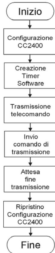
Figura 5.10. *Diagramma di flusso della trasmissione*
