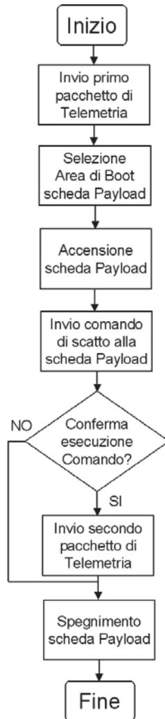
Figura 4.18. *Diagramma di flusso della fase di scatto fotografia*
